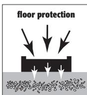
La version standard de l'arceau de protection MORION est équipée d'un socle flexible en polyuréthane. L'élément en PU, résistant aux UV et à l'élasticité permanente, absorbe les forces élevées de choc sur l'arceau.
