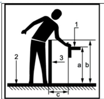
**Remarque :** il y a également des distances minimales à respecter entre l'intérieur d'un panneau grillagé et la zone dangereuse.
