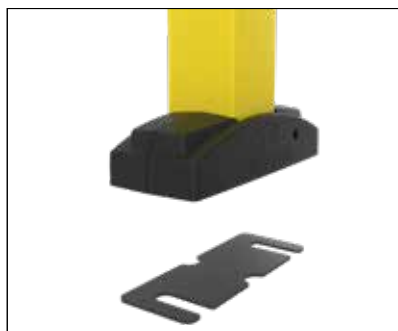
T01-04 (50x50) / T01-25 (70x70) jeu de cales Permettent d'ajuster la hauteur des poteaux X-Guard lorsque le sol est irrégulier. Il existe deux jeux de cales selon le type de poteau que vous utilisez.
