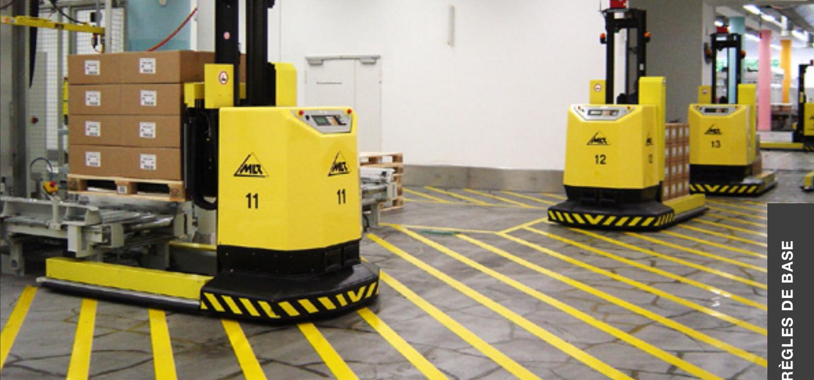
Véhicule à guidage automatique (VGA) de MLR
