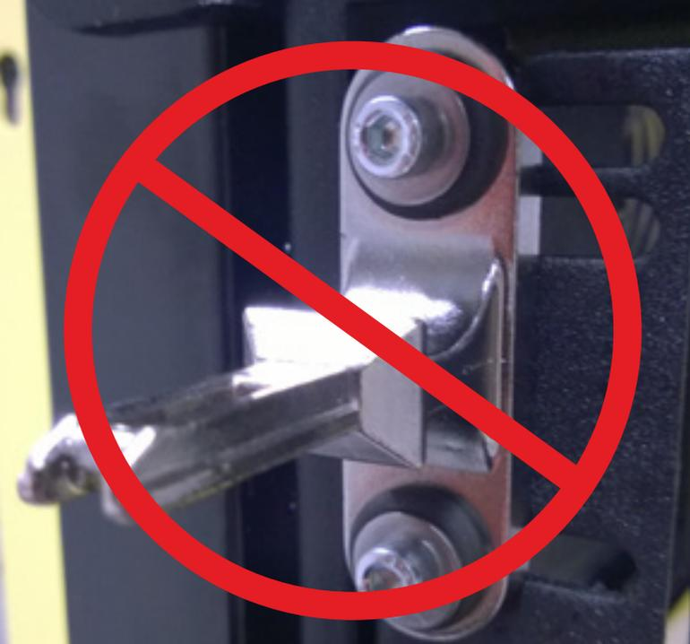
Interdit : actionneur fixé avec des vis normales
