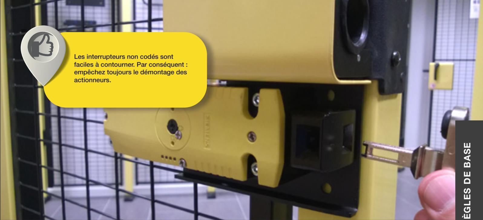
Légende : interrupteur de sécurité mécanique avec actionneur séparé. Facile à manipuler.
