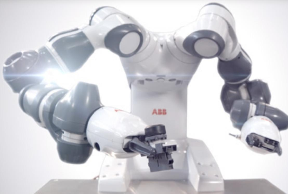
YuMI, le robot collaboratif d'ABB, fonctionne sans barrière ou autre équipement de sécurité, sauf s'il manipule des objets tranchants ou pointus tels que des lames ou des seringues. Ceci est possible grâce à des mesures intégrées à la conception du bras de robot et du système de commande (conforme à l'EN ISO 10218-1, point 5.10.5)
